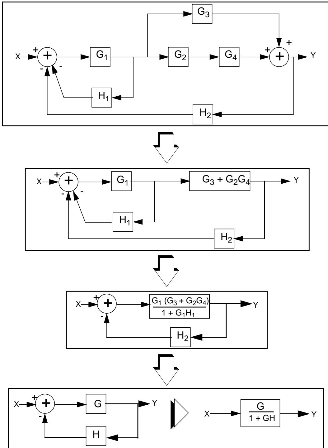
$$T(s) = \frac{Y(s)}{X(s)} = \frac{G_1(G_3 + G_2G_4)/(1 + G_1H_1)}{1 + H_2G_1(G_3 + G_2G_4)/(1 + G_1H_1)} = \frac{G_1(G_3 + G_2G_4)}{1 + G_1H_1 + H_2G_1(G_3 + G_2G_4)}$$
